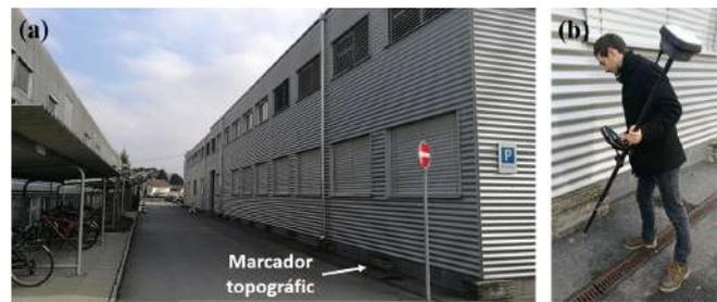
**Figura 13** - Prueba de posicionamiento RTK en un entorno multipath fuerte (longitud del bastón: 1,800 m) (a) Marca de medición cerca de un edificio con fachadas metálicas, (b) Medición RTK con compensación de inclinación con el Leica GS18 T.
