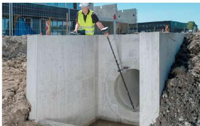
**Figura 3** - Uso del Leica GS18 T para medir esquinas de edificios y puntos obstruidos que antes no eran medibles en la medición RTK convencional con un bastón vertical.
